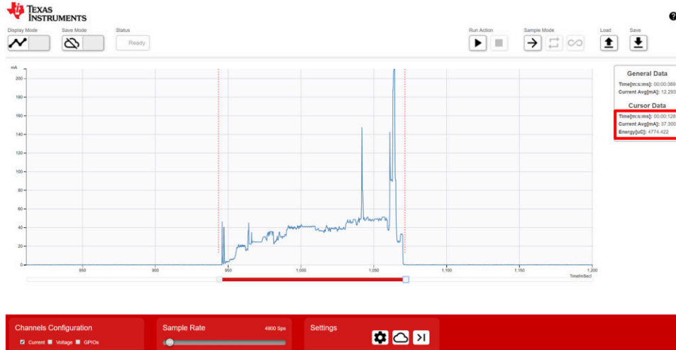
图 2-12. 使用 IMETER-BOOST 器件测量的平均电流
