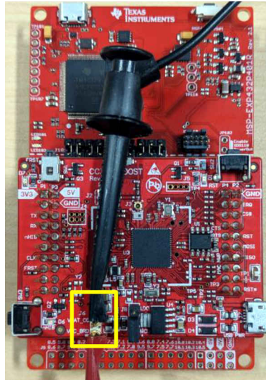
图 2-9. 电流测量工具连接到 CC3135 器件
