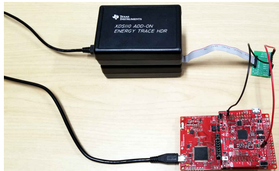
图 2-22. XDS110 系统的 CC3135 器件测试设置
