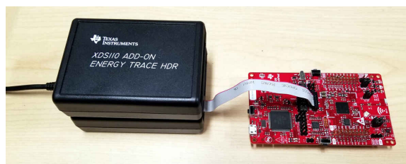
图 2-23. XDS110 系统的 CC3235x 器件测试设置
