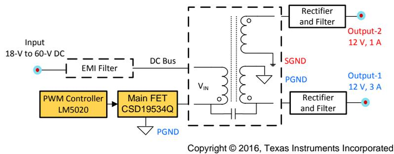
**Figure 2. TIDA-00711 Block Diagram**
