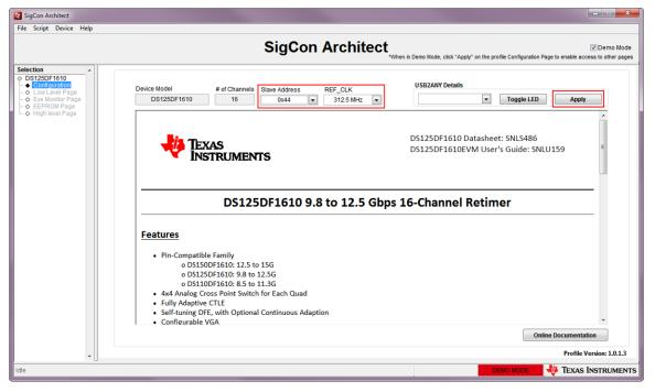
Figure 8. SigCon Architect—Configuration
