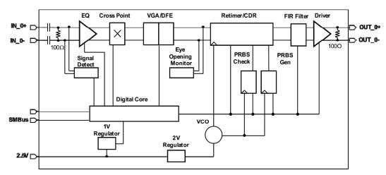
Figure 1. DS125DF1610 Simplified Data Path Diagram
