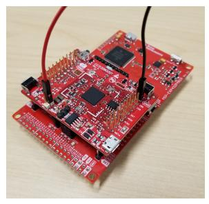
Figure 21. XDS110 ETHDR Connection to CC3120 Device
