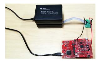
Figure 26. CC3120 Device Test Setup With XDS110 System
