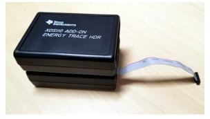
Figure 19. XDS110 Probe and ETHDR System
