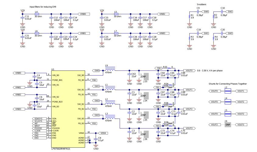
Figure 29. LP87562Q1EVM Schematic
