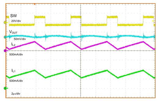
Figure 1. -5V<sub>IN</sub> -12V<sub>OUT</sub> 300mA I<sub>OUT</sub>
