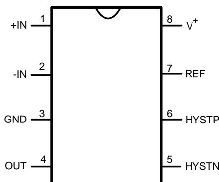
**Figure 2. 8-Pin VSSOP/SOIC Top View**
