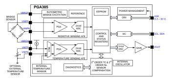
Figure 4. PGA305 Block Diagram
