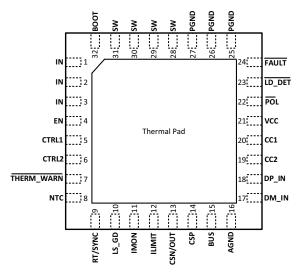
Figure 4-1. TPS25833QCWRHBRQ1 Pin Diagram
