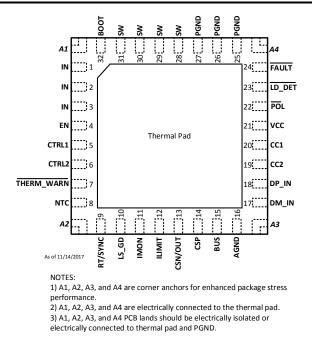
Figure 4-2. TPS25833QWRHBRQ1 Pin Diagram
