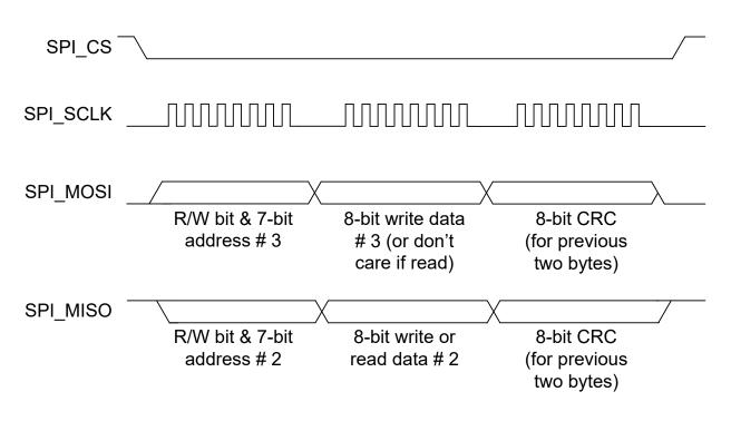
Figure 9-7. SPI Transaction #3 Using CRC
