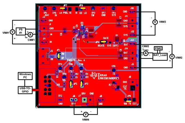
Figure 4. Original Test Setup for bq24260, bq24261, bq24262EVM (bq2426xEVM-079)
