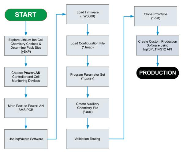
Figure 1-1. PowerLAN<sup>™</sup> BMS Development Cycle
