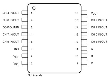
Figure 4-1. Pin Diagram (TSSOP) Package
