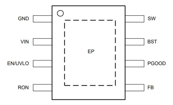
Figure 4-1. Pin Diagram
