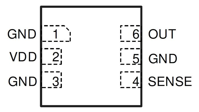
Figure 4-1. Pin Diagram
