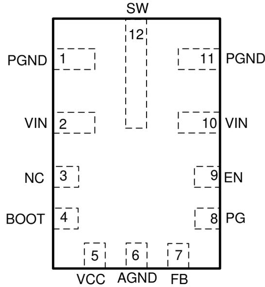
**Figure 4-1. Pin Diagram**
