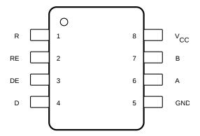
Figure 4-1. Pin Diagram
