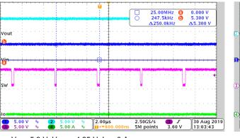
$V_{\rm IN}$  = 5.3 V,  $V_{\rm OUT}$  = 4.95 V,  $I_{\rm O}$  = 0 A
