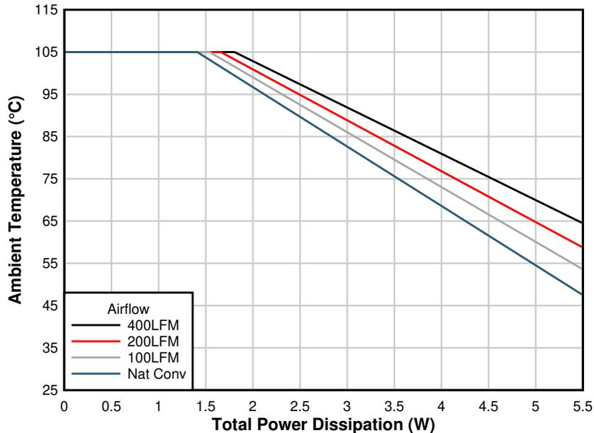
**图 7-6. Ambient Temperature Versus Total Power Dissipation**
