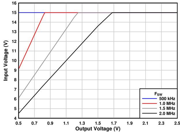
图 7-3. Maximum Input Voltage
