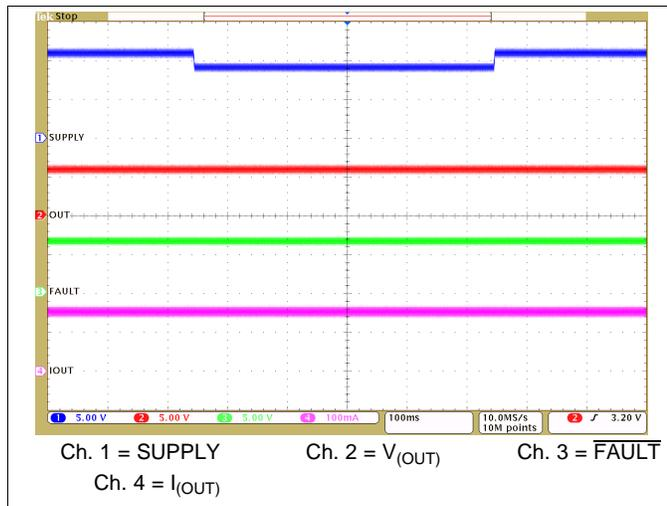
图 10. Transient Undervoltage
