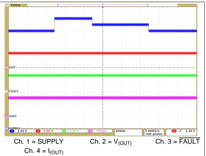
图 11. Transient Overvoltage
