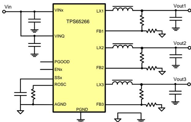
其中的 DC/DC 降压转换器集成了功率 MOSFET, 用于优化功率效率并减少外部使用的元件数量。峰值电流模式简化了补偿并提供快速瞬态响应。高时钟频率允许采用更小的低值电感和电容。外部补偿可支持优化环路补偿并提供快速瞬态响应。轻载条件下, FCC 模式的降压转换器可减轻噪声敏感性并减少射频干扰。出现短路或过载故障条件时, 断续模式周期性限流功能可限制 MOSFET 功耗。
