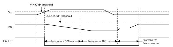
Figure 14. V<sub>IN</sub> Overvoltage Protection (V<sub>IN</sub> OVP)
