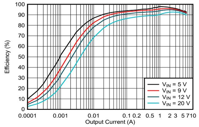
图 5-2. 效率与输出电流间的关系，
