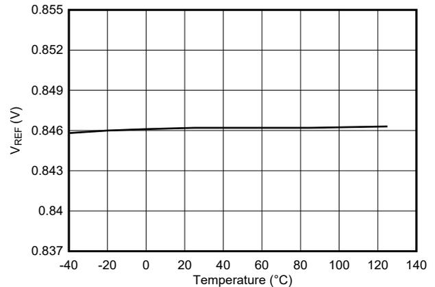
图 5-14. 基准电压与温度间的关系 ( $V_{REF} = 0.846V$ )
