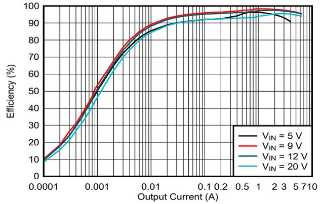
图 5-4. 效率与输出电流间的关系，
