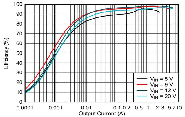
图 5-6. 效率与输出电流间的关系，
