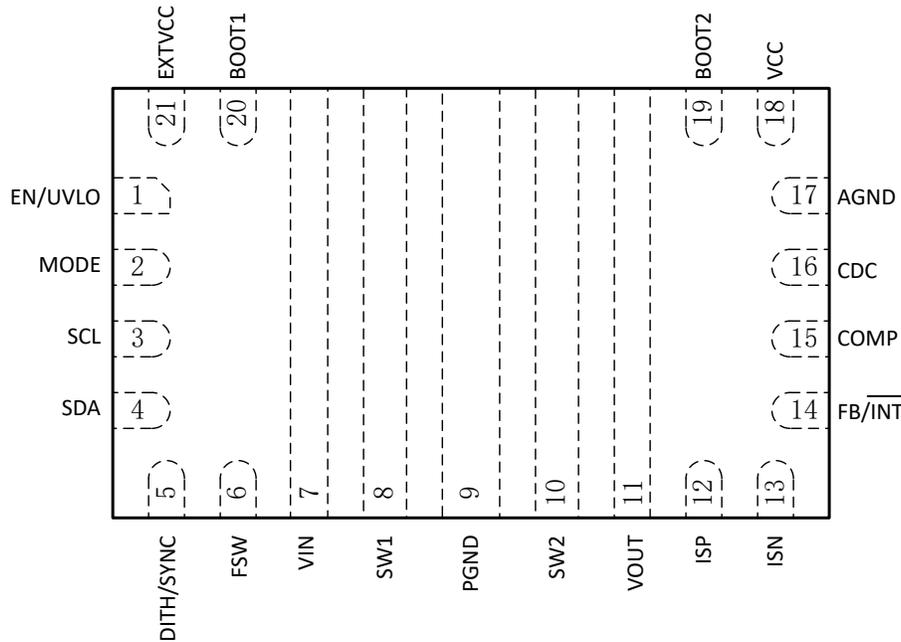
图 4-1. 21 引脚 VQFN-HR、RYQ 封装 (透明顶视图)
