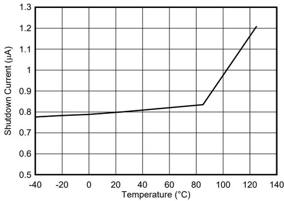
图 5-17. 关断电流与温度间的关系
