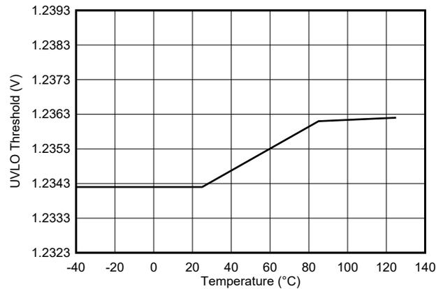
图 5-18. ENABLE/UVLO 上升阈值与温度间的关系
