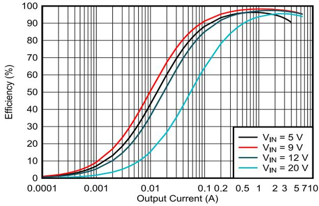
图 5-3. 效率与输出电流间的关系，
