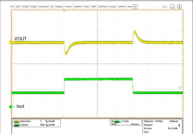
图 8-11.  $V_{IN} = 12V$ 、 $V_{OUT} = 5V$ 、 $I_O = 2.5A$  至  $5A$ 、 $20\mu s$  转换率时的负载瞬态波形，FPWM
