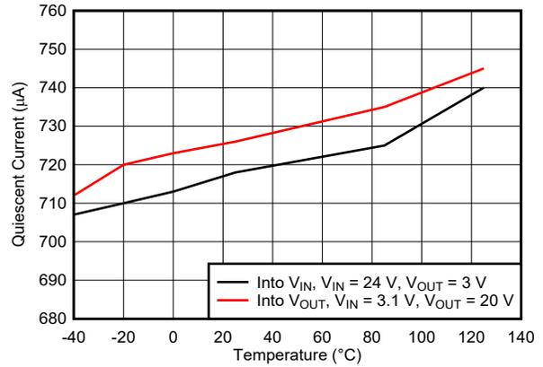
图 5-16. 静态电流与温度间的关系
