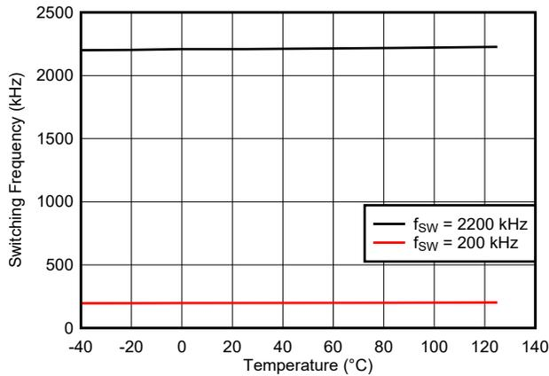
图 5-19. 开关频率与温度间的关系
