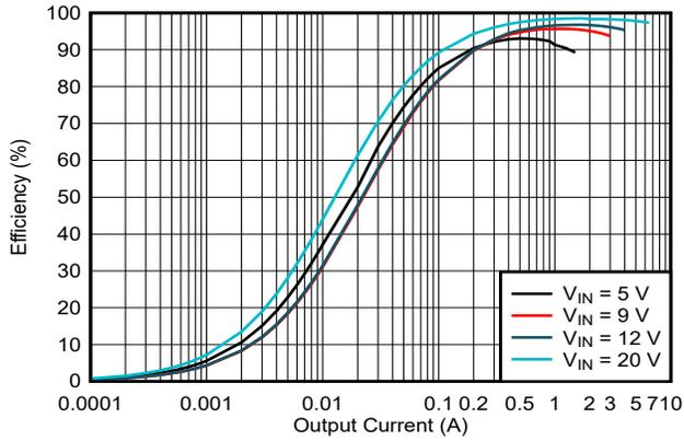
图 5-9. 效率与输出电流间的关系，
