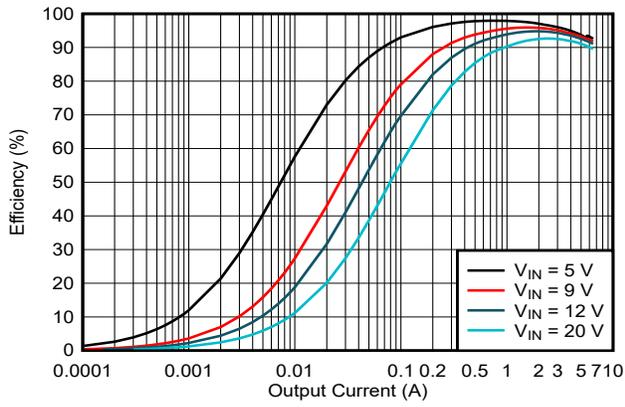
图 5-1. 效率与输出电流间的关系，
