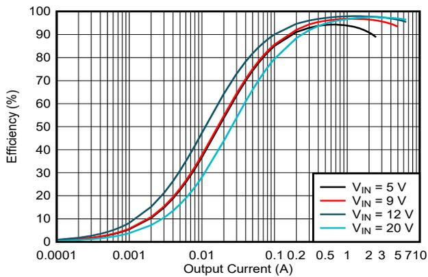
图 5-7. 效率与输出电流间的关系，
