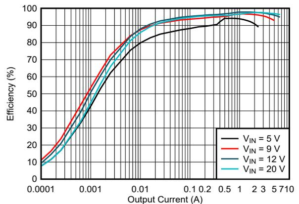
图 5-8. 效率与输出电流间的关系，
