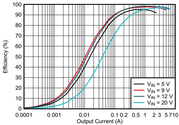
图 5-5. 效率与输出电流间的关系，
