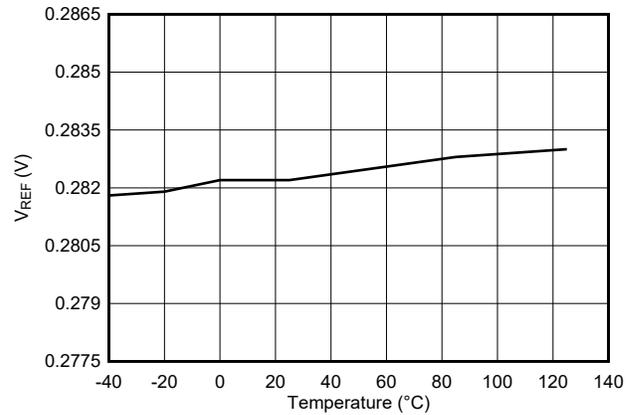
图 5-12. 基准电压与温度间的关系 ( $V_{REF} = 0.282V$ )
