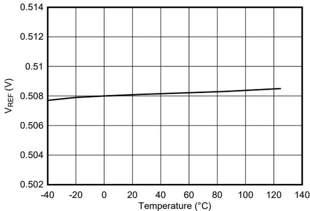
图 5-13. 基准电压与温度间的关系 ( $V_{REF} = 0.508V$ )
