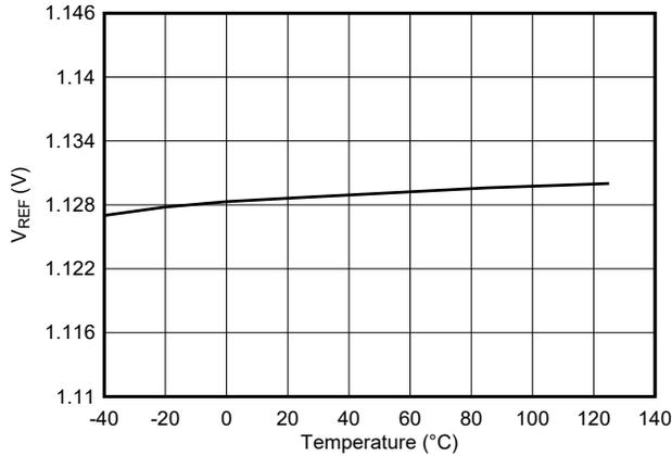
图 5-15. 基准电压与温度间的关系 ( $V_{REF} = 1.129V$ )
