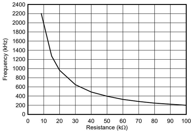
图 5-11. 开关频率与设置电阻间的关系
