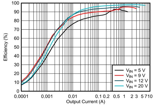
图 5-10. 效率与输出电流间的关系，
