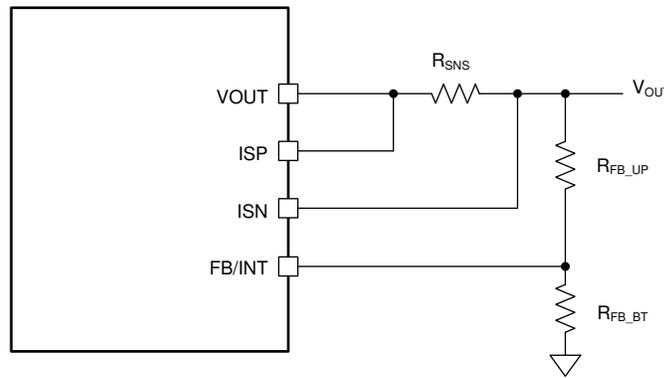
图 6-5. 由外部电阻分压器设置输出电压
