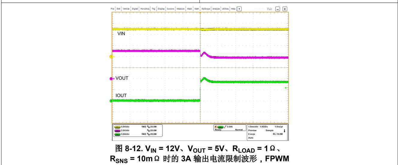
图 8-12.  $V_{IN} = 12V$ 、 $V_{OUT} = 5V$ 、 $R_{LOAD} = 1\Omega$ 、 $R_{SNS} = 10m\Omega$  时的 3A 输出电流限制波形，FPWM
