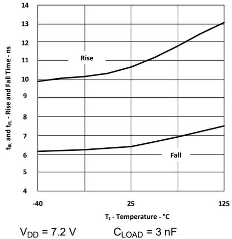
图 6-9. LGATE Rise and Fall Time vs Temperature
