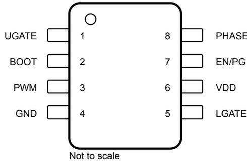
图 5-1. D Package 8-Pin SOIC Top View
