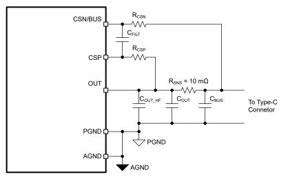
图 10-5. Current Sense Amplifier: RC Filter Components
