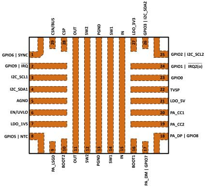
图 6-1. RQL Package 29-Pin (VQFN) Top View
