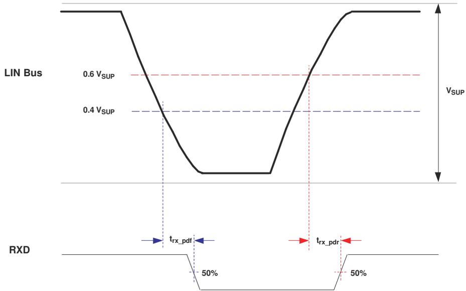
图 8-2. Propagation Delay
