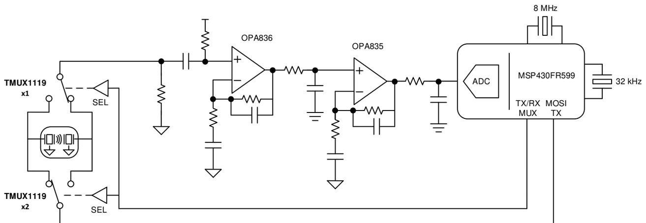
图 8-1. Ultrasonic Gas Meter System
