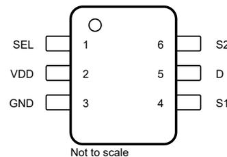
图 4-2. DBV Package, 6-Pin SOT-23 (Top View)
