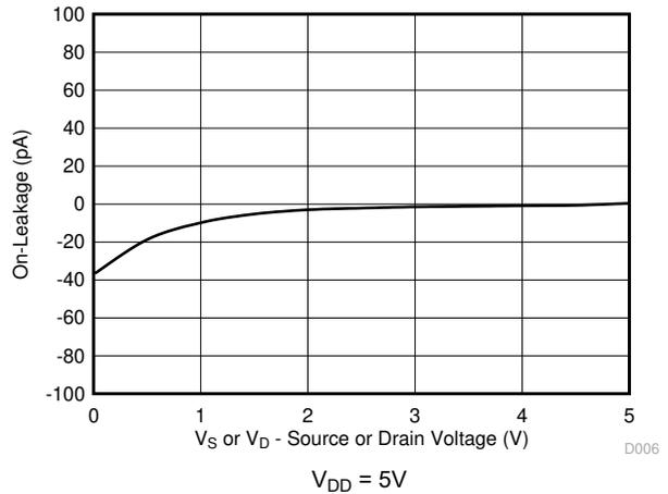
图 5-6. On-Leakage vs Source or Drain Voltage
