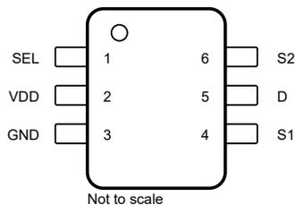
图 4-1. DCK Package, 6-Pin SC70 (Top View)
