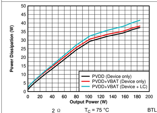
图 7-11. Power Dissipation vs Output Power - 14.4 V - 2  $\Omega$
