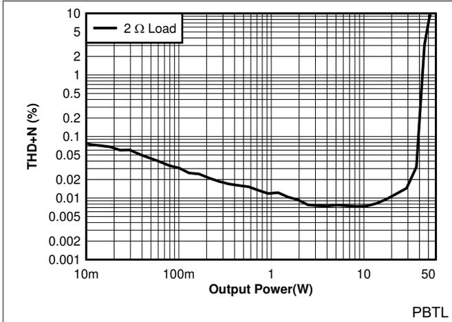
图 7-37. THD+N vs Power - PBTL - 384kHz
