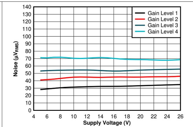
图 7-14. Noise vs Supply Voltage
