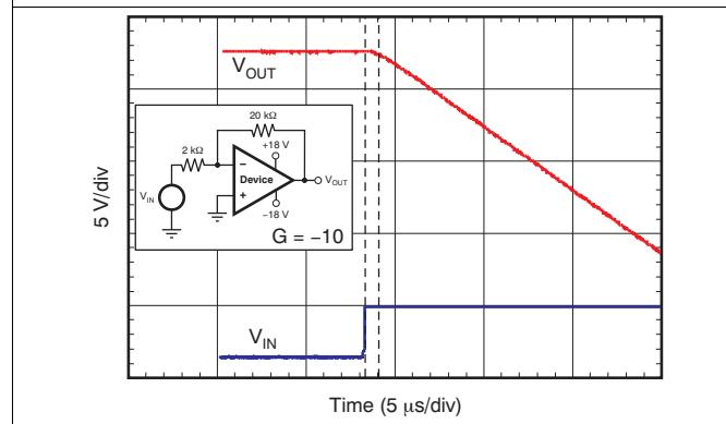
**Figure 27. Positive Overload Recovery**
