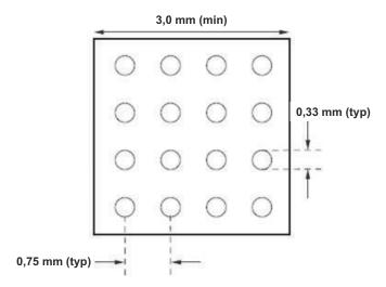
图 10-7. Recommended PCB Layout
