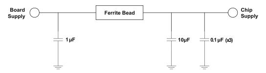
图 10-6. Power Supply Decoupling
