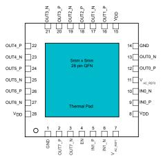
图 6-2. LMK1D2104: RHD Package 28-Pin VQFN Top View
