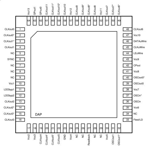
图 4-1. NKD Package 64-Pin WQFN Top View
