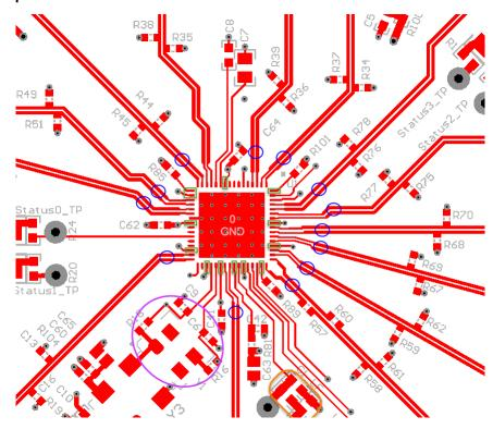
图 8-15. LMK03806 Layout Example
