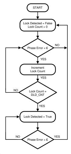
图 8-6. Digital Lock Detect Flow Diagram
