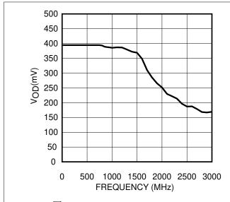
图 5-2. LVDS V<sub>OD</sub> vs Frequency
