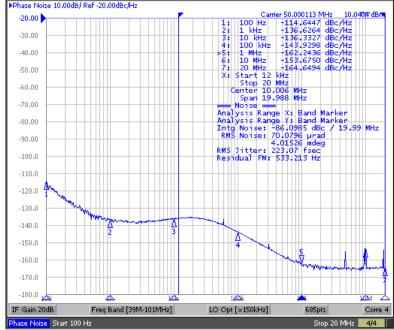
图 8-10. LVCMOS Phase Noise, 50 MHz
