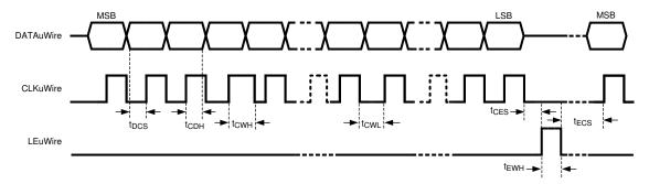
图 5-1. MICROWIRE Timing Diagram
