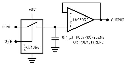
**图 6-9. Low-Leakage Sample-and-Hold**
