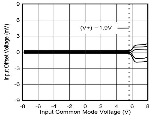
图 5-2. Offset Voltage vs Input Common-Mode Voltage
