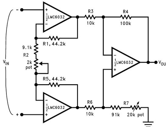
图 6-6. Instrumentation Amplifier
