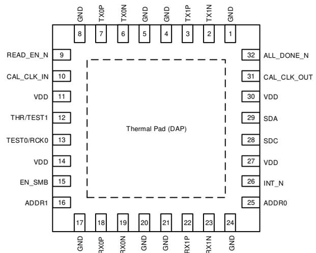
图 6-2. RTV Package 32-Pin QFN Top View
