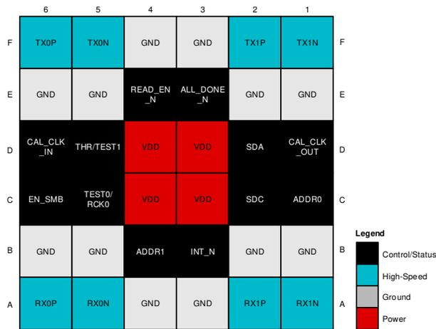
图 6-1. ZLS Package 36-Pin NFBGA Top View
