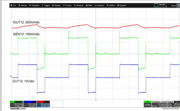
图 8-11. 显示电流调节的放大波形
