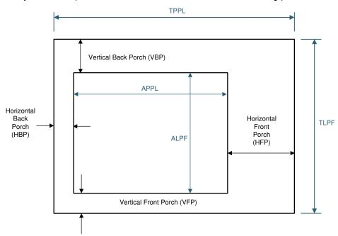
图 11-1. Timing Parameter Diagram
