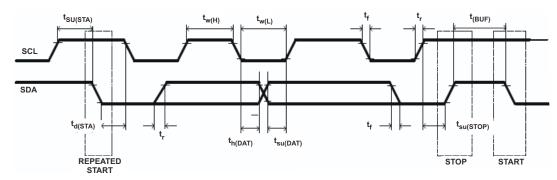
图 6-1. I<sup>2</sup>C-Compatible Interface Timing Diagrams
