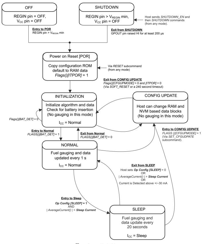
图 7-5. Power Mode Diagram
