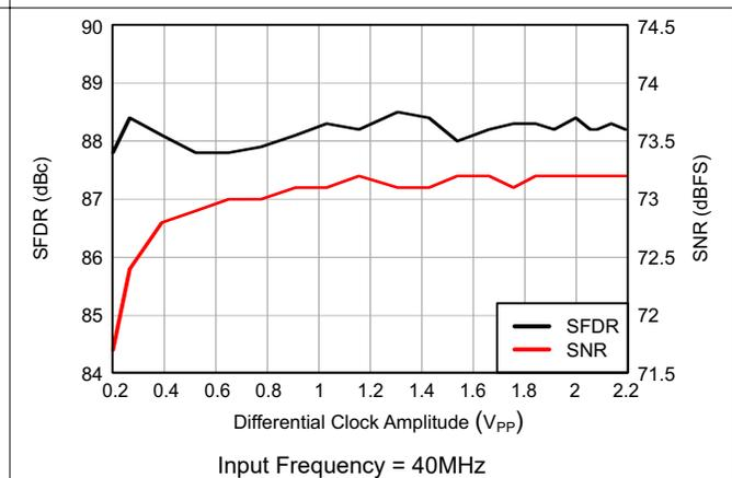
图 6-23. Performance vs Input Clock Amplitude
