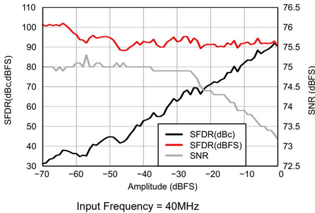
图 6-16. Performance vs Input Amplitude
