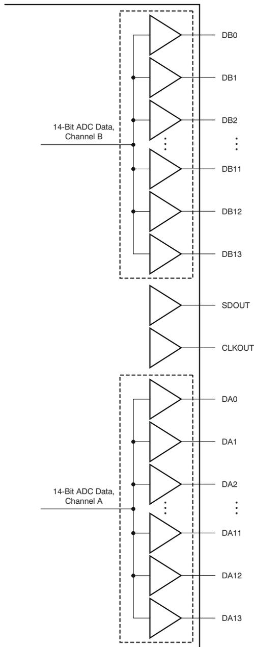
**图 7-6. CMOS Outputs**
