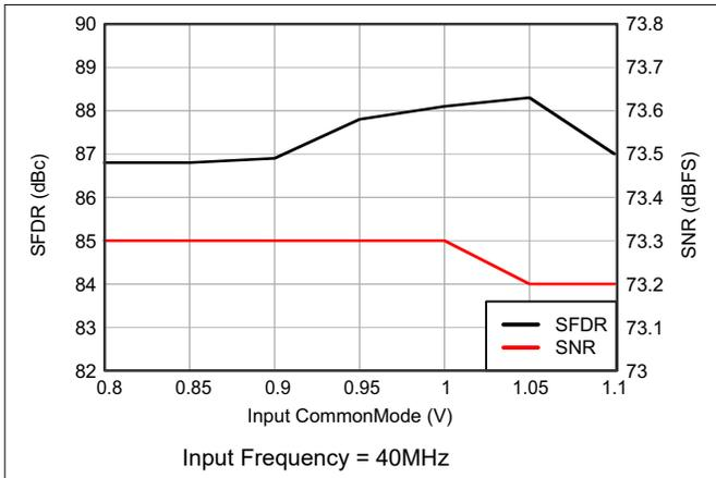
图 6-18. Performance vs Input Common-Mode Voltage
