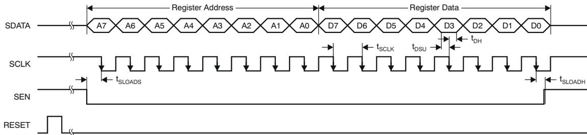
**图 7-9. Serial Interface Timing**
