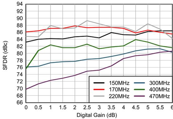
图 6-14. SFDR vs Gain And Input Frequency
