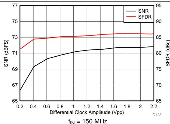
图 28. Performance vs Clock Amplitude
